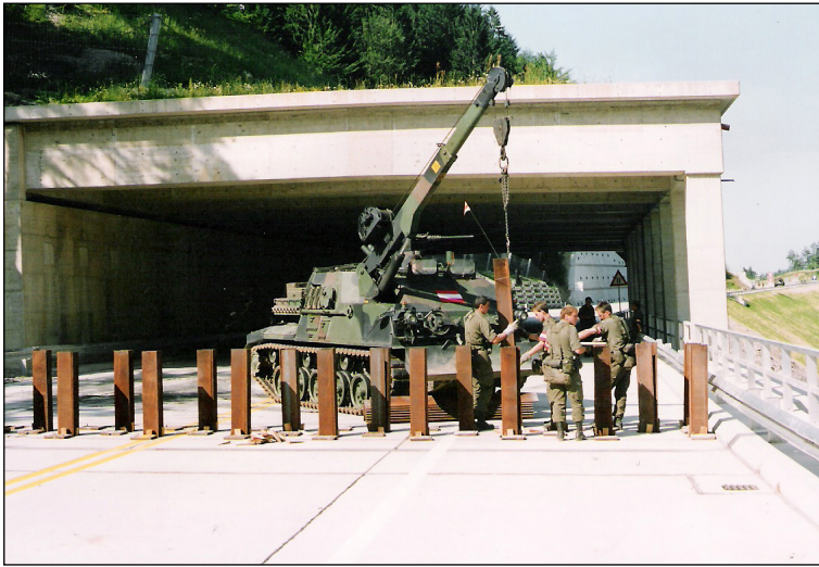
Aktivieren der Steckperren beim Karawankentunnel durch einen Bergepanzer „Greif“. Im Hintergrund sichern Jagdpanzer „Kürassier“. Bildarchiv: Thomas Lampersberger
