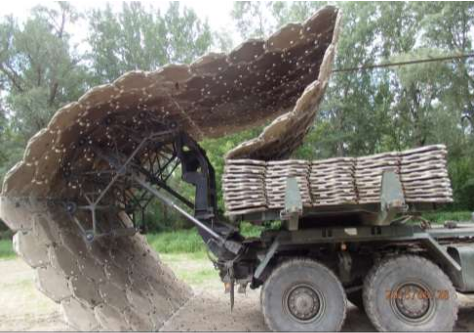
Mit dem Faltstraßengerät wird das sumpfigste Gelände im Handumdrehen befahrbar!
